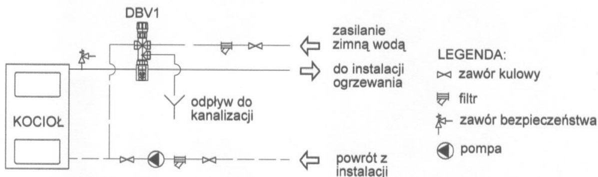
Rys.3 Schemat instalacji z dwudrogowym zaworem bezpieczeństwa DBV1.
