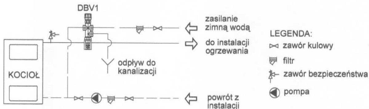
Rys.5 Schemat instalacji z dwudrogowym zaworem termostatycznym DBV1.
