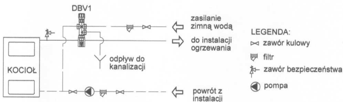
Rys.8 Schemat instalacji z dwudrogowym zaworem bezpieczeństwa DBV1.
