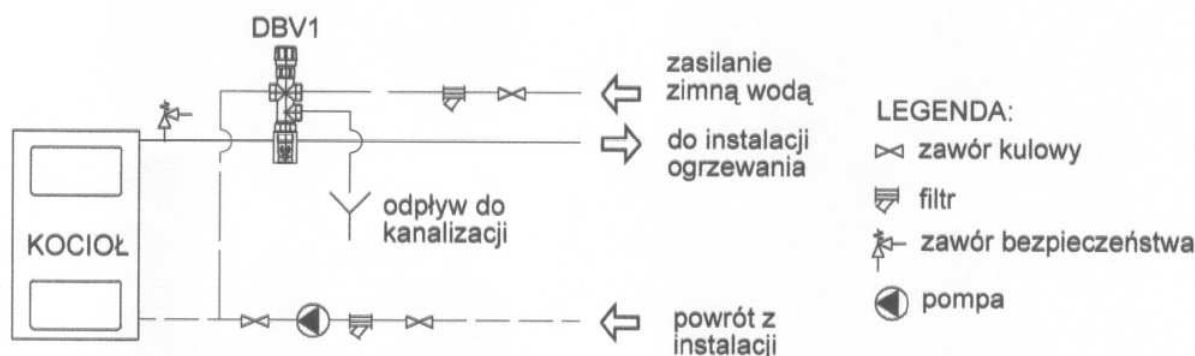
Rys.4 Schemat instalacji z dwudrogowym zaworem bezpieczeństwa DBV1.
