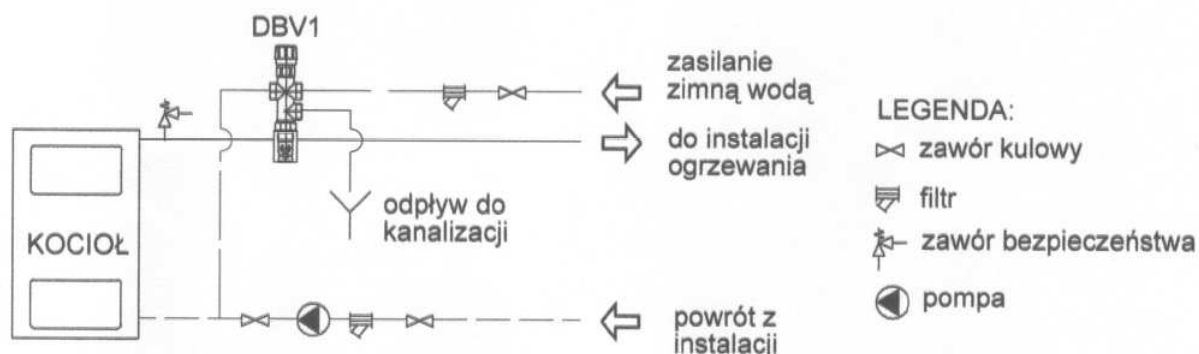
Rys.3 Schemat instalacji z dwudrogowym zaworem bezpieczeństwa DBV1.
