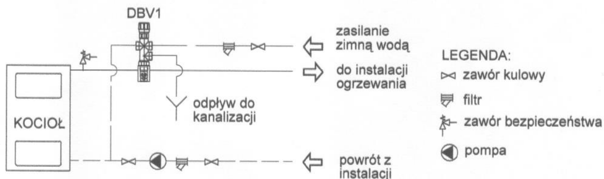
Rys.5 Schemat instalacji z dwudrogowym zaworem bezpieczeństwa DBV1.
