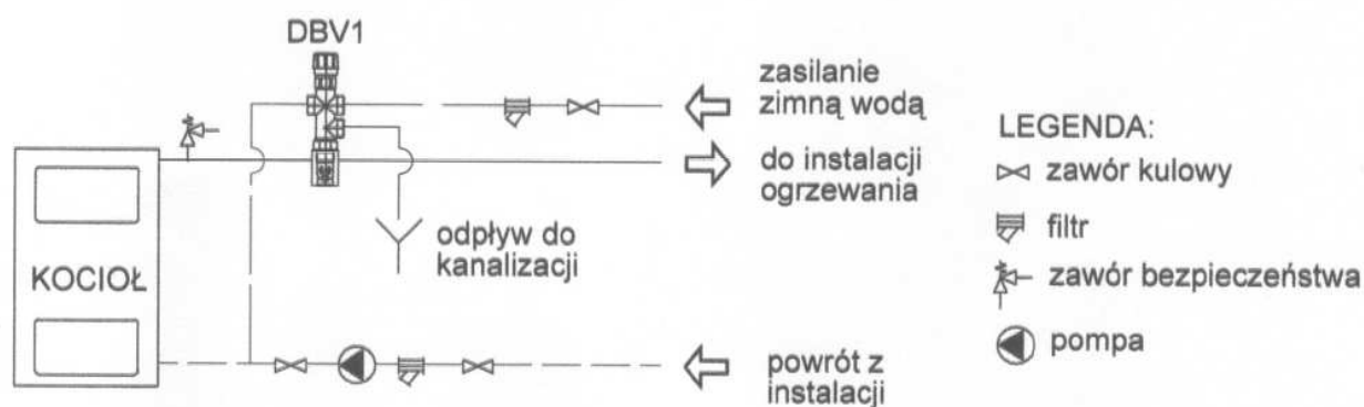
Rys.6 Schemat instalacji z dwudrogowym zaworem bezpieczeństwa DBV1.
