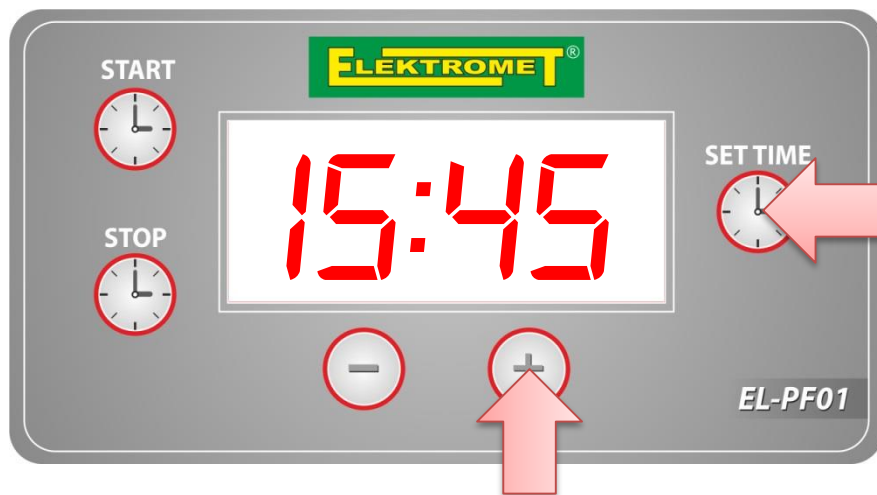
Ustawienie aktualnej godziny – jednocześnie przycisk SET TIME i przycisk ”+” lub ”-”
