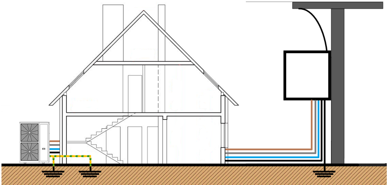
Rys. 24a. Przykładowy schemat podłączenia elektrycznego (uziemienia) pompy ciepła.
