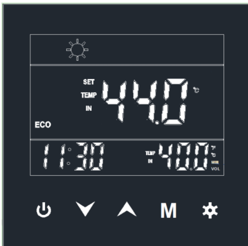
Rys. 38. Główny panel sterownika pompy ciepła pracującej w trybie grzewczym.
