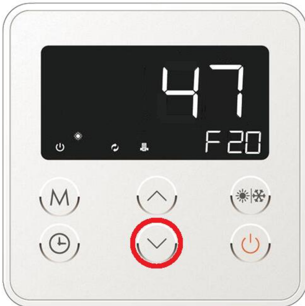
Rys. 17b. Zmiana wartości danego parametru pracy urządzenia.
