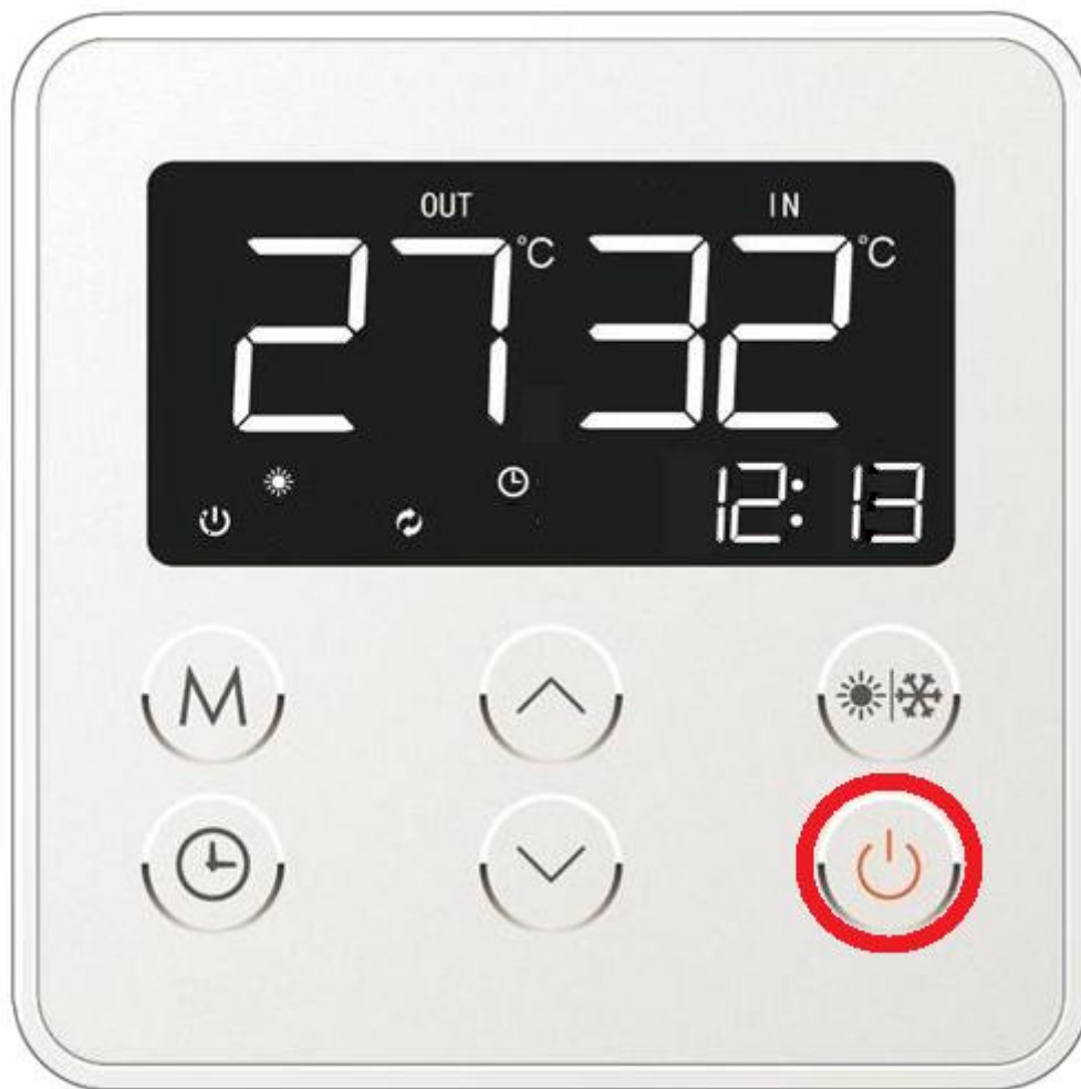
Rys. 12g. Aktywacja funkcji czasowych sterownika urządzenia.
