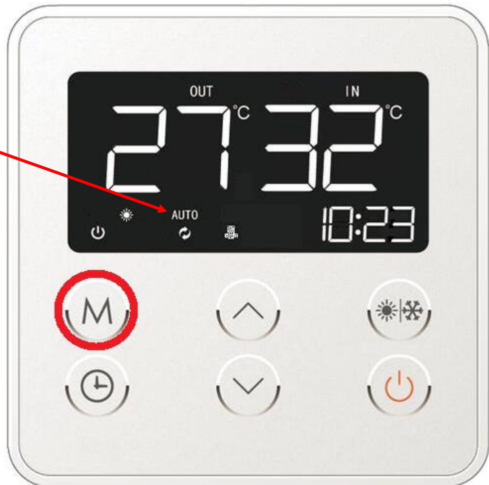
Rys. 9. Wybór reżimu pracy pompy ciepła.
