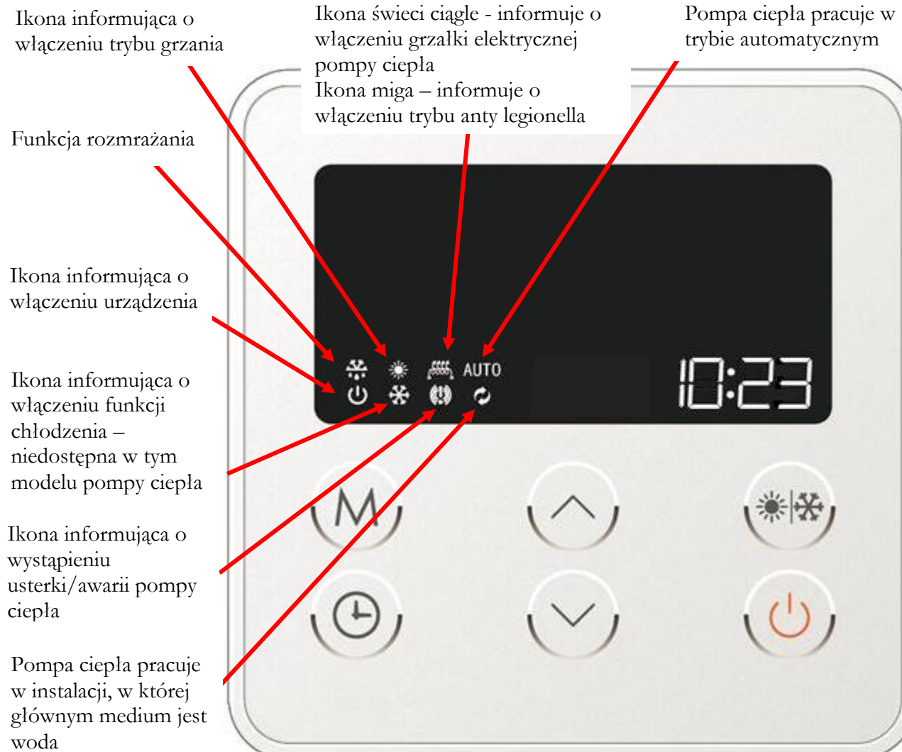
Rys. 3. Ikony obrazujące aktualny stan pracy urządzenia.
