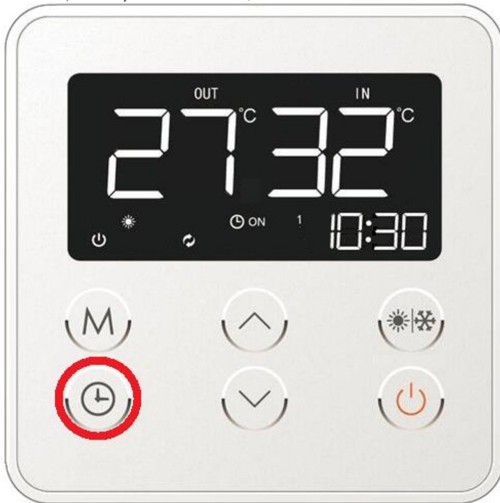
Rys. 12f. Wybór funkcji czasowych sterownika urządzenia.
