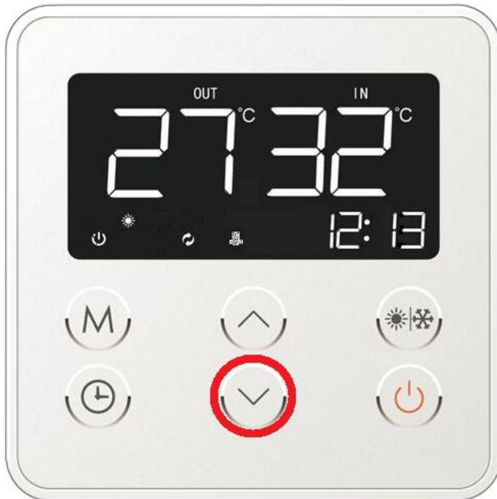
Rys. 11c. Edycja parametrów minut z wykorzystaniem klawiszy funkcyjnych
