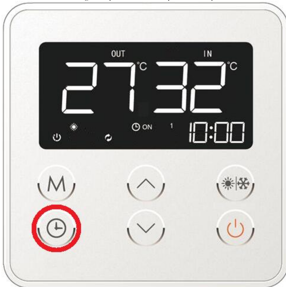
Rys. 12c. Zatwierdzenie ustawienia godziny włączenia w trybie czasowym.
