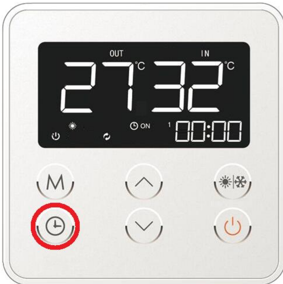
Rys. 12. Wejście w ustawienia funkcji czasowego włączenia oraz wyłączenia pracy pompy ciepła.
