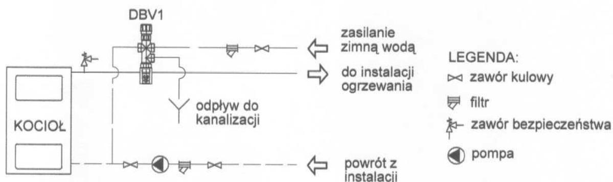
Rys.6 Schemat instalacji z dwudrogowym zaworem bezpieczeństwa DBV1.
