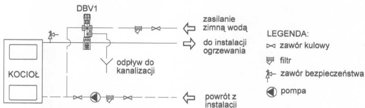
Rys.6 Schemat instalacji z dwudrogowym zaworem bezpieczeństwa DBV1.
