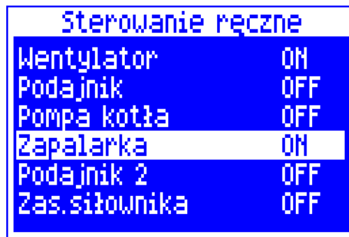
Rys. 12 Widok okna sterowania ręcznego, gdzie OFF – oznacza, że urządzenie jest wyłączone, ON – załączone,
