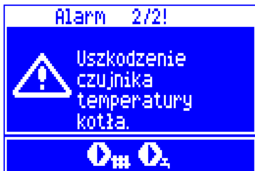
Rys. 40 Widok alarmu „uszkodzenie czujnika temperatury kotła”
