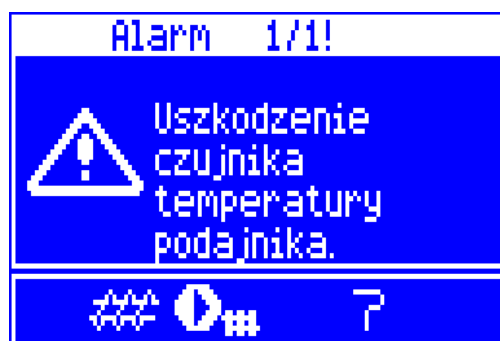
Rys. 41 Widok alarmu „uszkodzenie czujnika podajnika”
