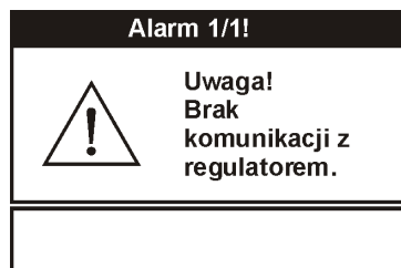
Rys. 53 Widok alarmu „brak komunikacji”
