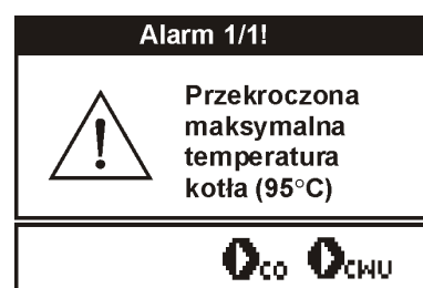
Rys. 50 Widok alarmu „przegrzania maksymalnej temperatury kotła”
