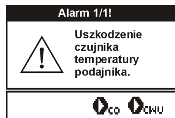
Rys. 52 Widok alarmu „uszkodzenie czujnika podajnika”
